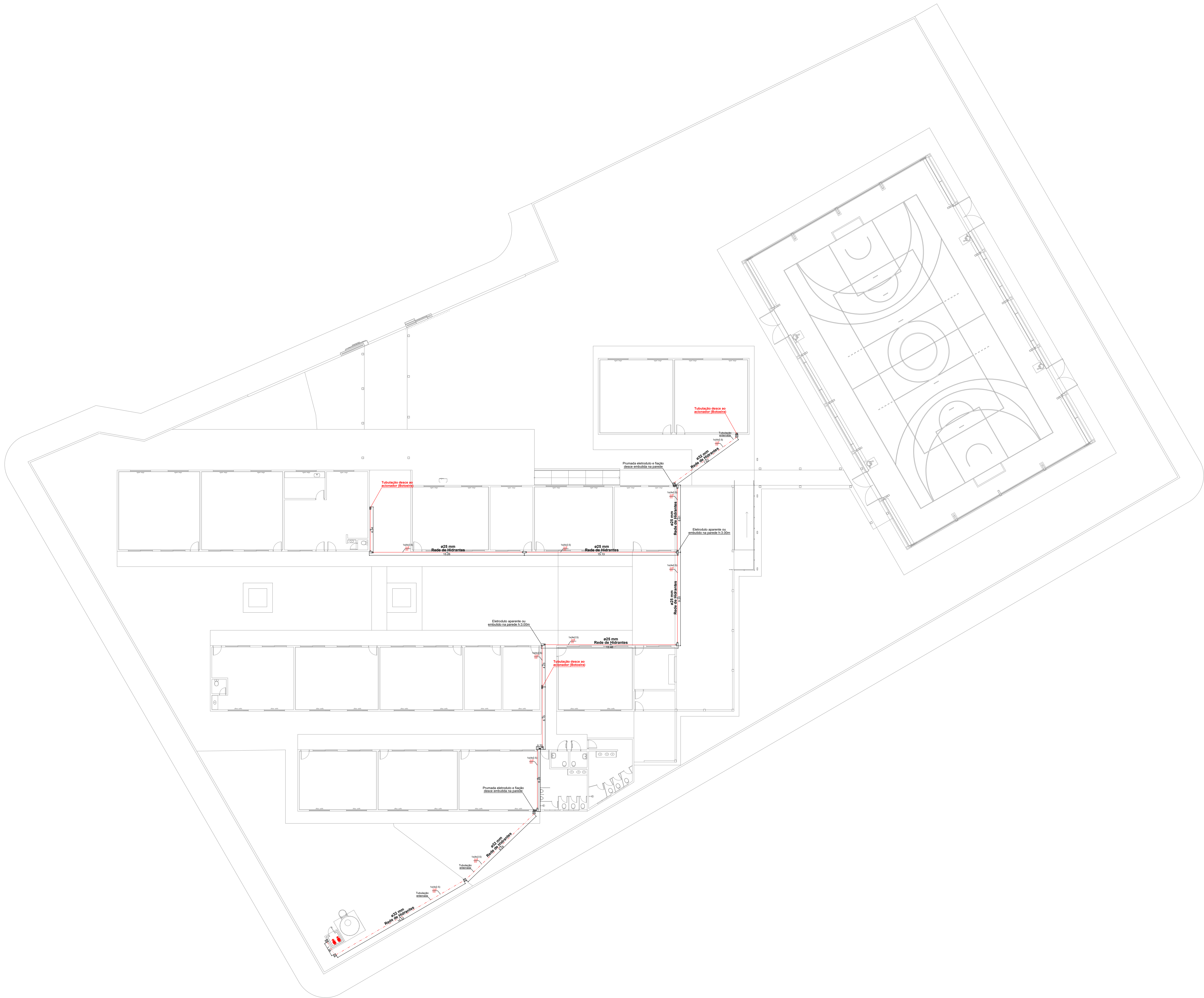
Planta baixa - Infraestrutura Rede de Hidrantes escala 1:200
