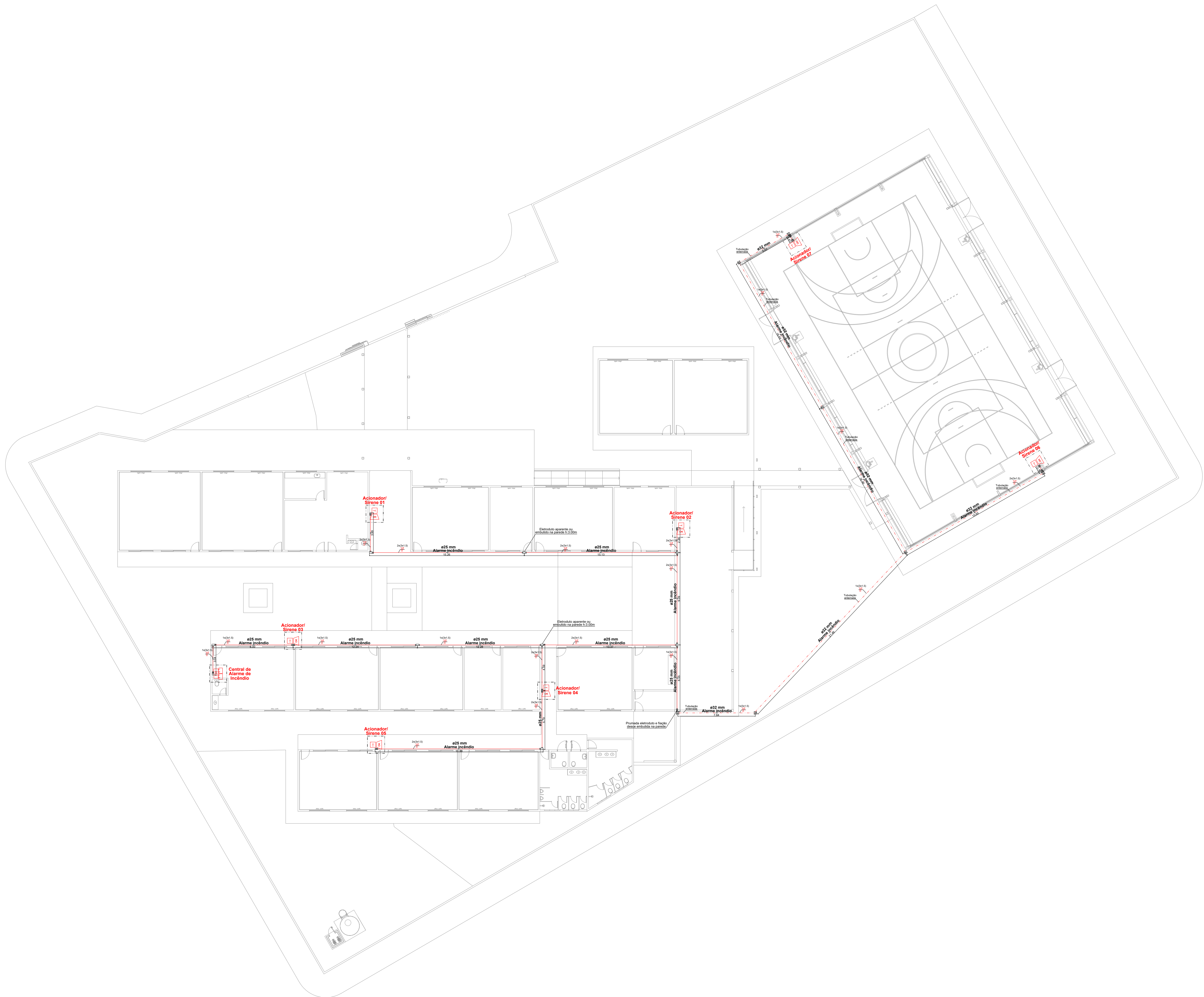
Planta baixa - Alarme de incêndio escala 1:200
