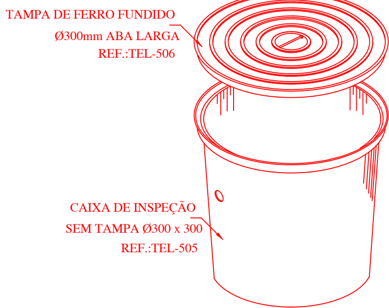
DETALHE DA CAIXA INSPEÇÃO TIPO SOLO DETALHE 04
